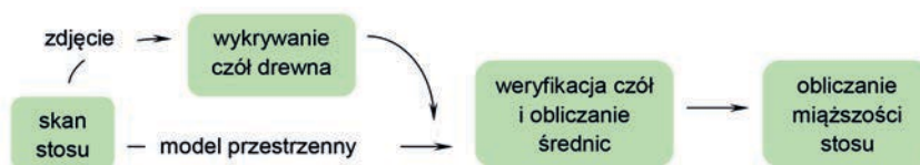
Rycina 1. Etapy algorytmu elektronicznego obliczania miąższości drewna (ryc. P. Mederski)
