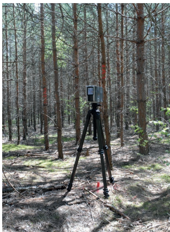
Rycina 6. Skanowanie na wybranej powierzchni kołowej, widoczne numery drzew próbnych przeznaczonych do wycięcia (Nadleśnictwo Dobieszyn)
