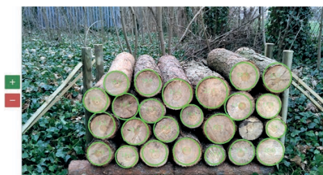
Rycina 2. Pierwszy etap działania algorytmu – rozpoznawanie okręgów (czoł) po automatycznym procesie filtrowania
