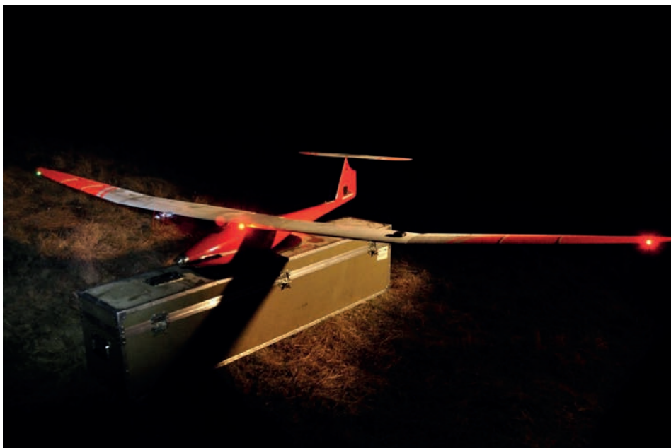
Rycina 1. Samolot bezzałogowy AVI-1 przystosowany do wykonywania lotów nocnych
