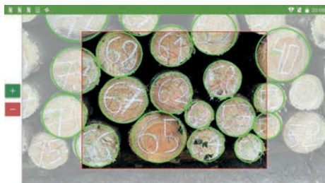
Rycina 4. Elektro WZ: aplikacja wzbogacona o funkcję ramki, której pole powierzchni wykorzystano do obliczania współczynnika zamiennego
